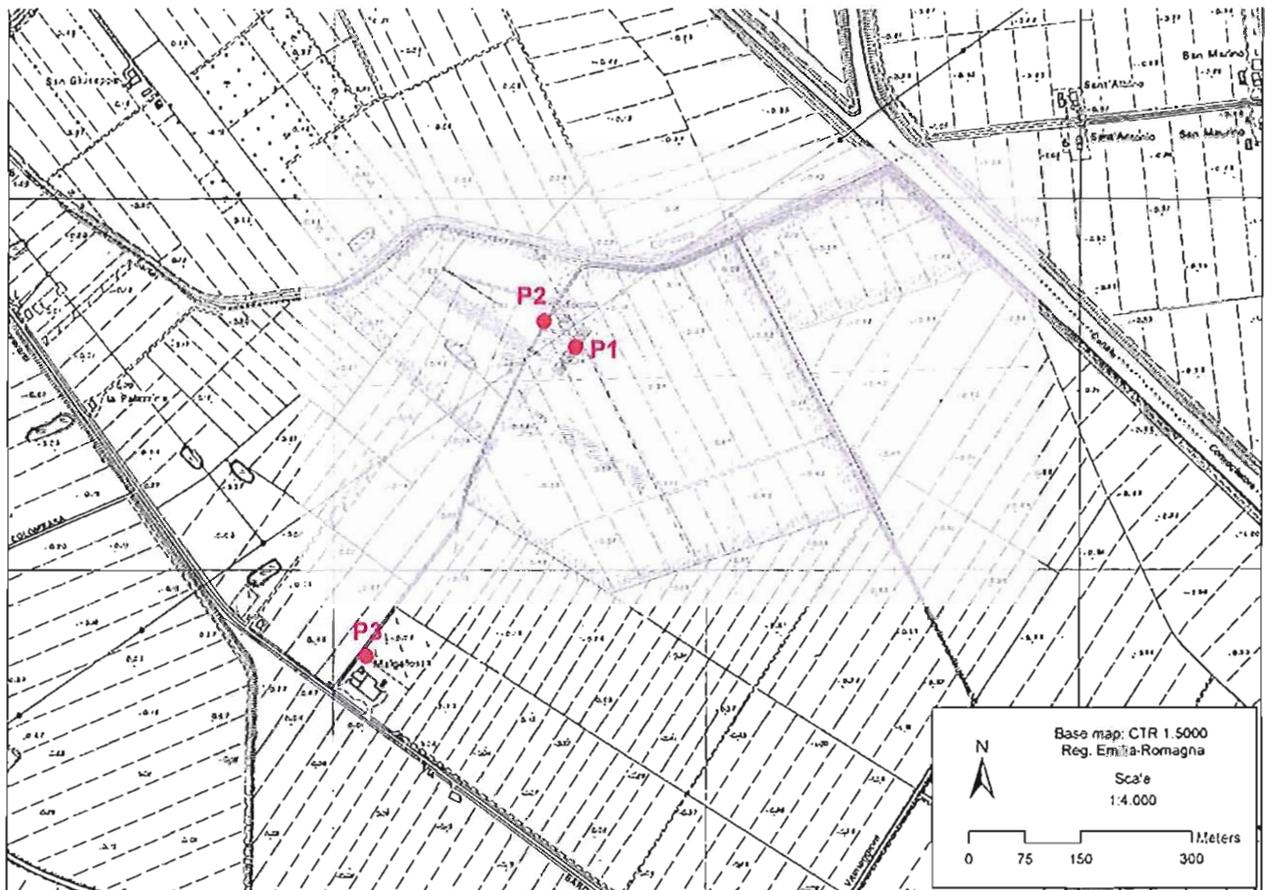
Figura 2: CTR della Regione Emilia Romagna, scala 1:5000 con sovrapposizione, mediante sistema GIS, dell'area di progetto. In rosso sono evidenziati i punti di rilievo presso l'area di progetto (P1 e P2) e presso il ricettore (P3).
