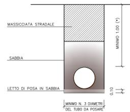
(\*) PER RICOPRIMENTI INFERIORI A m. 1,00 E' NECESSARIO REALIZZARE UNA SOLETTA IN CALCESTRUZZO SP. cm 15 ARMATA CON DOPPIA RETE ELETTRODILATA 80/15x15 SOPRA LA TUBAZIONE, CON FUNZIONE DI RIPARTIZIONE DEI CARICHI
