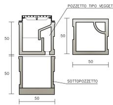
N.B.: Il collegamento di una caditoia con la rete fognante sarà eseguita con condotta in PVC tipo UNI EN 1401 SN 8 #125, 2 caditoie con ø160.
