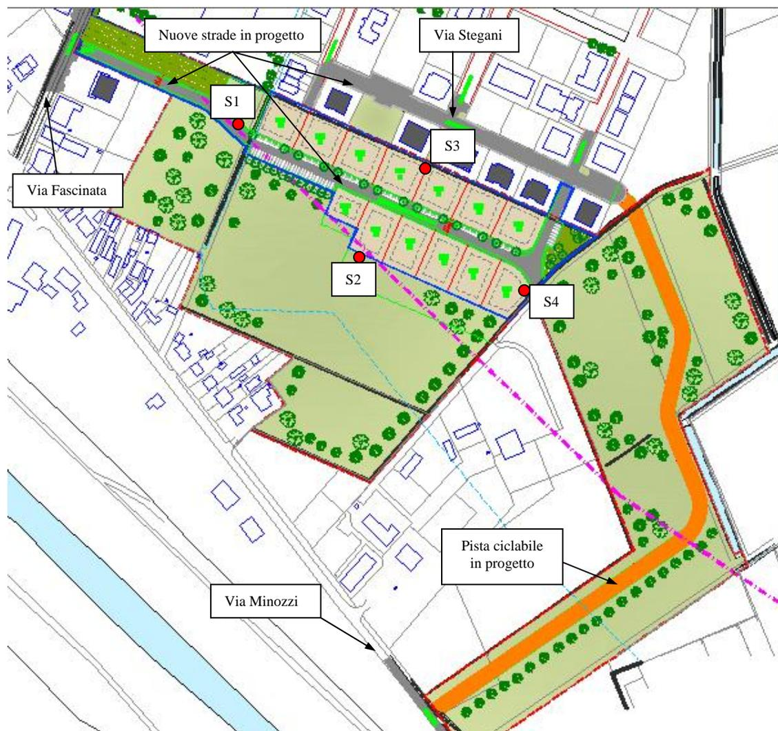
**Fig. 2.1:** Planimetria di progetto con ubicazione stazioni di misura.
