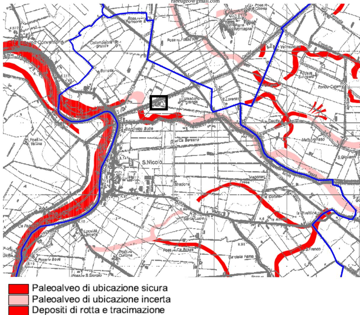
Fig. 3/3: Stralcio a Scala Libera della apposita Carta Geomorfologica del P.S.C. di Argenta (Tav. b.2.1.c del Quadro Conoscitivo, alla scala 1: 25 000) e Legenda.
