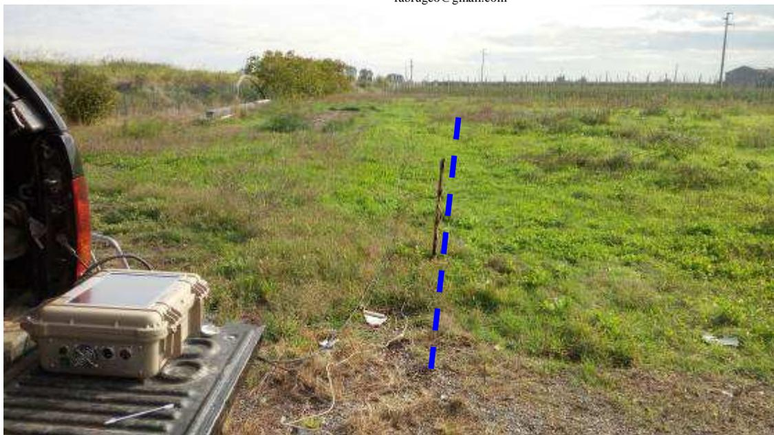
Fig. 10/14: esecuzione dello Stendimento Re.Mi.+M.A.S.W.
