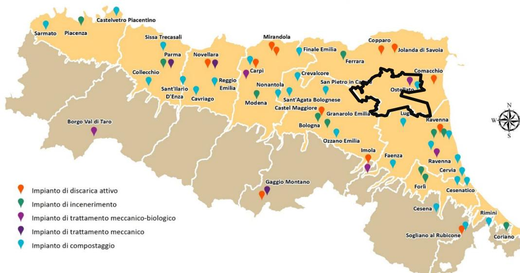
Figura 44 Individuazione dei principali impianti di discarica, incenerimento, TM/TMB ed impianti di compostaggio (fonte: Arpa, Report2018 “La gestione dei rifiuti in Emilia-Romagna”)
