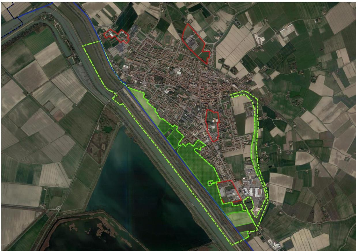
Figura 10 - Azioni per il potenziamento dell'infrastruttura verde (in verde) ed interventi di riqualificazione (in rosso)
