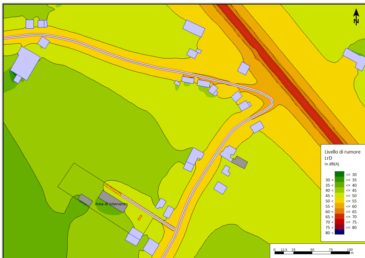
Figura 10 – Mappatura curve isofoniche (H = 4.0 m sul p.c.) nel periodo diurno – Stato Progetto
