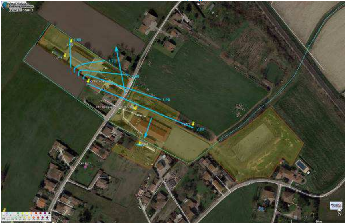
Fig. 5/1: Isobate della falda superficiale a Scala Libera. Profondità della falda in metri dal p.c. con andamento della profondità della falda freatica (indicazione della direzione di gradiente idraulico il quale è particolarmente ridotto: 10 cm su 25 m circa ovvero assolutamente trascurabile, come normale per i territori di pianura). L'estensione alle aree contermini –Ragioni Donigaglia, è funzionale ad una corretta caratterizzazione tematica.
