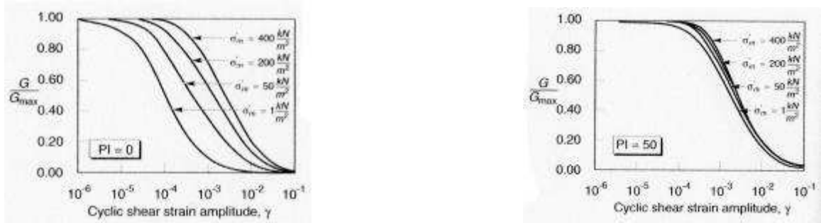
Fig. 6/20: Influenza della pressione di confinamento e della plasticità sul modulo di deformazione al taglio.
