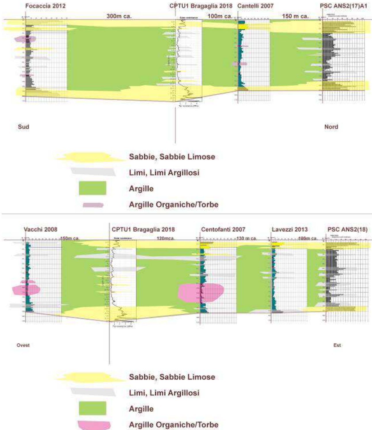
Fig. 3/5 e 3/6: Sezioni Nord- Sud ed Est- Ovest degli intorno dell'area in esame. Scala Libera, scala orizzontale diversa da quella verticale. Onde addivenire ad una resa grafica accettabile non si sono rispettate le proporzioni fra le distanze.
