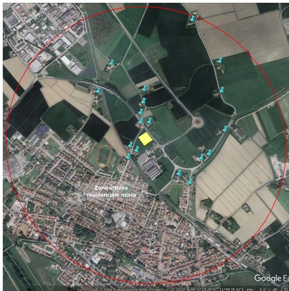
Figura 8 – Analisi effettuata sulla presenza di recettori residenziali nell'intorno dell'area individuata come alternativa Zero – n. 1 [Fonte: elaborazione del redattore attraverso l'utilizzo di Google Earth]
