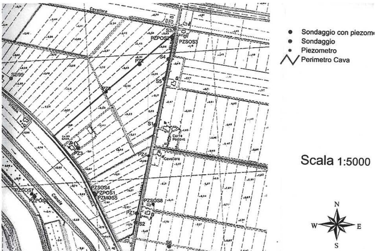
*Posizionamento dei sondaggi geologici (da Relazione Geologica)*
