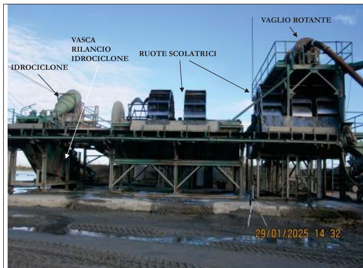
Figura 4 – Componenti dell'impianto di lavaggio e vagliatura
